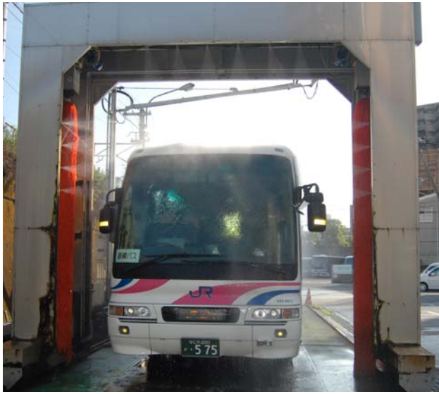
洗車直後に専用ノズルから RO 水を散水
